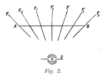
O l'objectif. La règle A B est dans un plan perpendiculaire à l'axe de l'objectif. Le focimètre F0 est dirigé vers le milieu de l'objectif et il est alors dans la direction de l'axe principal et ceux de côté F1, F—1, etc., dans la direction des rayons principaux, c'est-à-dire qu'ils se dirigent vers le point nodal d'incidence de l'objectif.
