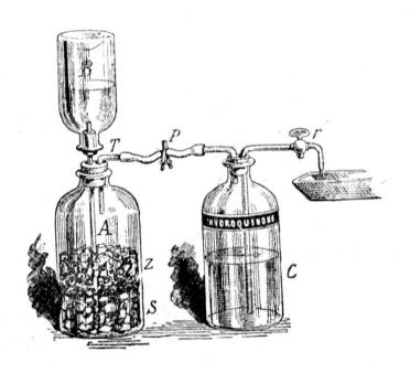
bouchon un tube de verre terminé par un robinet qui fera l'office de siphon.
