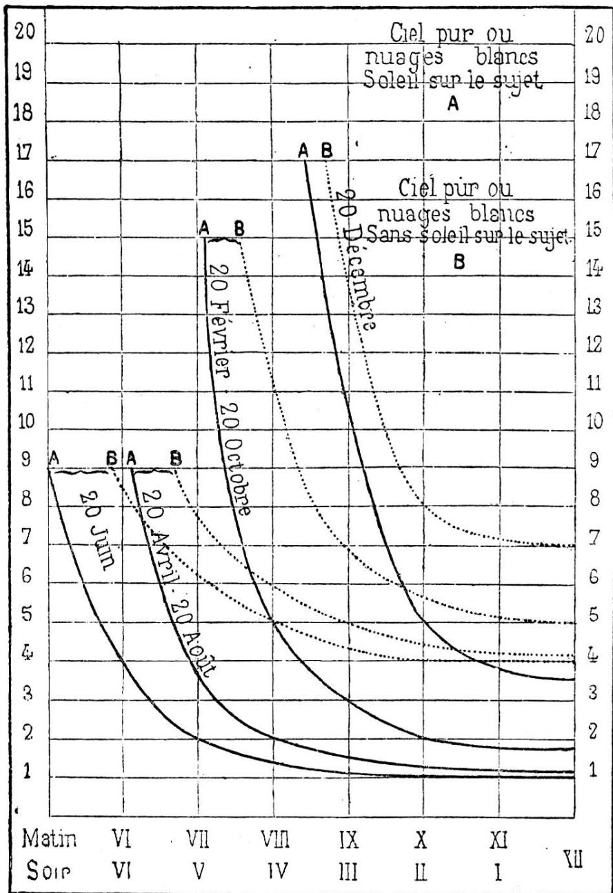
La détermination du temps de pose en secondes  $T$  est maintenant très facile : elle se réduit à la résolution de l'équation  $T = \alpha \times \beta \times \gamma \times \delta$ .
