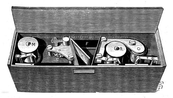
Fig. 45. — Chambre aux images, dont le couvercle est soulevé. M, bobine magasin, et R, bobine réceptrice sur leurs broches ; r r r, petits rouleaux compresseurs appuyant la bande sur les bobines. L, laminoir avec son rouleau compresseur. F, fenêtre d'admission. V, verre dépoli tournant à charnière. Une ligne ponctuée indique le trajet de la bande et de la pellicule. C, C°, fixateur et sa came produisant les arrêts intermittents de la bande.
