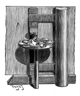
Fig. 16. — Fixateur C' de la figure précédente, représenté seul ici avec ses cames 0, p, bande pelliculaire que le fixateur comprime contre la paroi de la chambre aux images, chaque fois qu'une dent de la came passe sur le rouleau.
