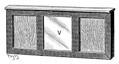
Fig. 10. — Châssis à verre dépoli V pour la mise au point dans la chronophotographie sur plaque fixe.
