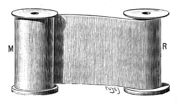
Fig. 14. — Bobine magasin chargée M; on déroule l'extrémité de la bande de papier qui la recouvre pour l'enrouler en sens contraire sur la bobine réceptrice R.
