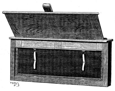
Fig. 41. — Châssis recevant la glace sensible dans la chronophotographie sur plaque fixe. Le volet du châssis est tiré.
