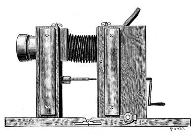
Fig. 8. — Disposition nouvelle de l'appareil, se prètant à toutes les applications de la chronophotographie. (Echelle 1/10.)
