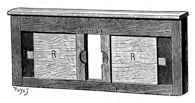
Fig. 12. — Fenètre d'admission se substituant au châssis photographique lorsqu'on opère sur une pellicule qui se déroule. La largeur de la fenètre se règle par le glissement des rideaux R R, suivant la dimension que doit avoir l'image.
