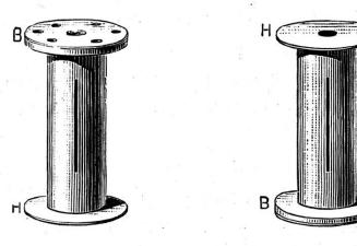
Fig. 13. — Deux bobines de métal destinées à l'enroulement de la pellicule sensible. Ces bobines sont situées en sens contraire l'une de l'autre; les lettres H et B indiquent sur chacune d'elles le haut et le bas.
