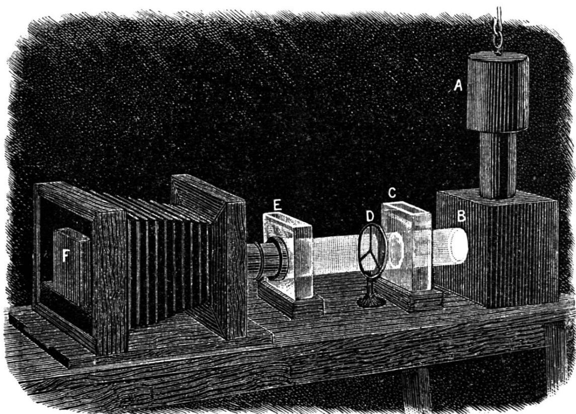
dans les expériences de M. Lippmann, fournie par une lampe à arc A du système Cance, d'une valeur de 800 bougies, placée dans une lanterne B munie d'un condensateur. La lumière solaire envoyée dans une chambre obscure au moyen d'un miroir serait certainement plus avantageuse, mais il faudrait pouvoir modifier souvent l'orientation du miroir, de manière que les rayons lumineux traversant
