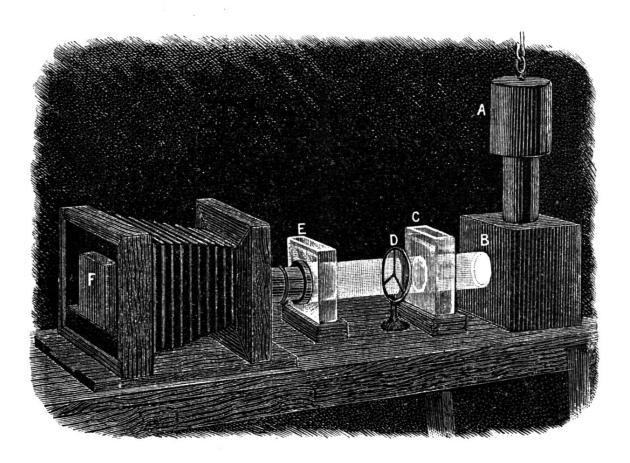
dans les expériences de M. Lippmann, fournie par une lampe à arc A du système Cance, d'une valeur de 800 bougies, placée dans une lanterne B munie d'un condensateur. La lumière solaire envoyée dans une chambre obscure au moyen d'un miroir serait certainement plus avantageuse, mais il faudrait pouvoir modifier souvent l'orientation du miroir, de manière que les rayons lumineux traversant
