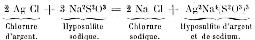
Cet hyposulfite d'argent et de sodium, dont la formule chimique peut aussi être représentée par  $2 \text{ Na}^2 \text{S}^2\text{O}^3$ ,  $\text{Ag}^2 \text{S}^2\text{O}^5$ , est un précipité blanc qui se dissout très bien dans l'hyposulfite sodique, c'est-à-dire dans le bain fixateur qui reste parfaitement limpide.
