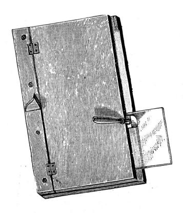
bord avec le trait portant la dimension choisie; on abat le couvercle et pendant qu'on le presse légèrement avec la main gauche, on passe le diamant le long du bord. Puis, posant le diamant, on saisit l'extrémité libre de la plaque, on appuie un coup sec, et la glace est coupée. La gélatine est ensuite séparée avec la pointe d'un canif.
