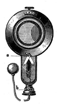
teur métallique, simple, solide et peu coûteux, il est d'un emploi facile, ne se détraque pas, et semble devoir en un mot remplacer les obturateurs connus jusqu'à ce jour. Cet appareil, qui est entièrement métallique, se place autour du parasoleil de l'objectif. Il fonctionne pour vues posées ou instantanées. Si nous n'en donnons pas la description, c'est que le dessin ci-dessus en fait comprendre le principal mécanisme 1.
