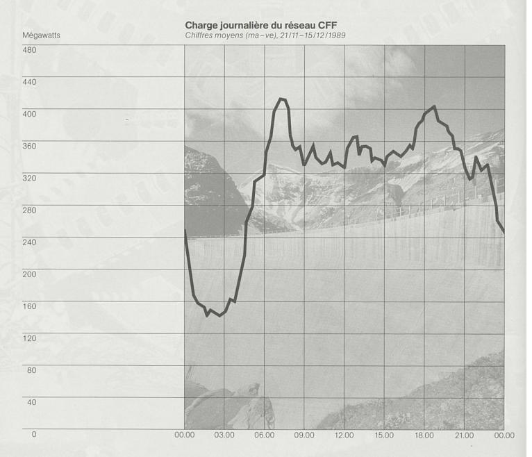
Variations de la consommation d'énergie des trains: Les usines d'accumulation par pompage permettent de produire du courant électrique en fonction de la demande. Le graphique fait apparaître les consommations de pointe du matin et du soir. A l'arrière-plan: barrage du Vieux-Emosson, usine de Châtelard-Barberine.
