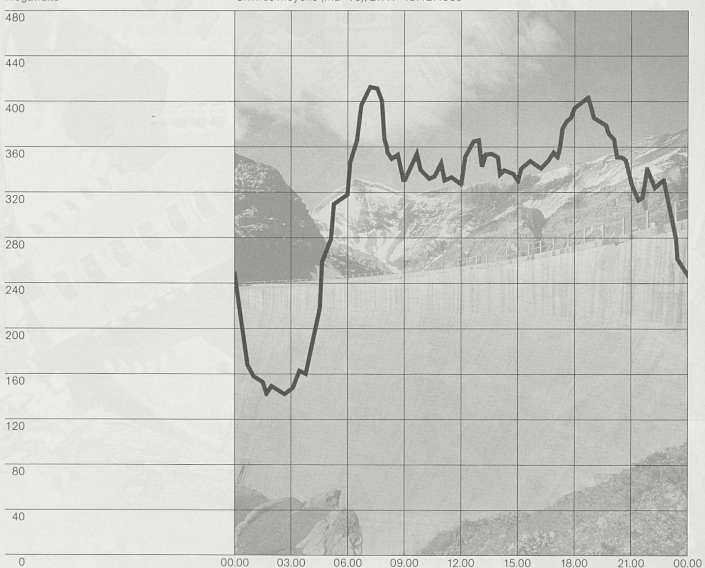
Variations de la consommation d'énergie des trains: Les usines d'accumulation par pompage permettent de produire du courant électrique en fonction de la demande. Le graphique fait apparaître les consommations de pointe du matin et du soir. A l'arrière-plan: barrage du Vieux-Emosson, usine de Châtelard-Barberine.
