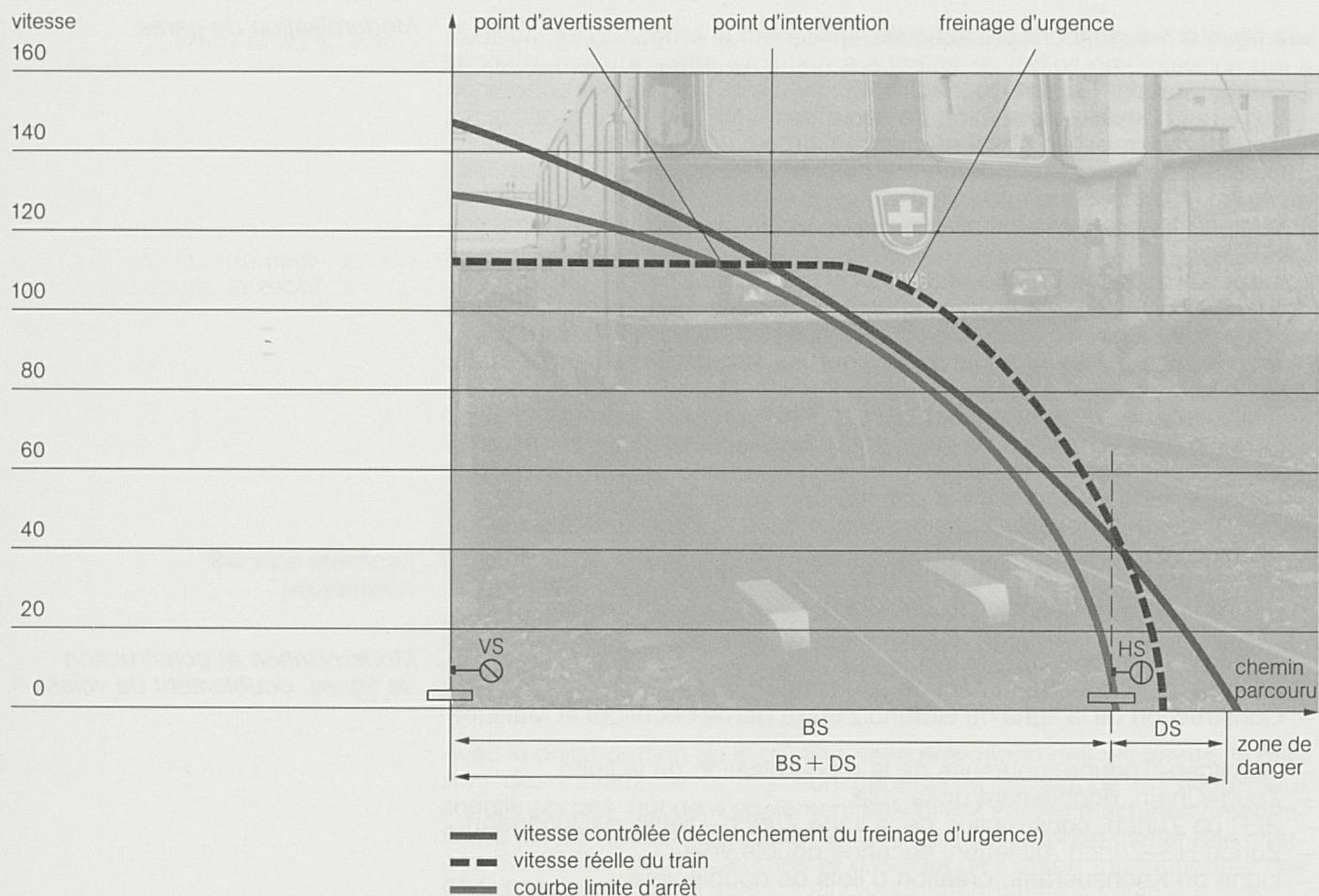
*VS = signal avancé présentant l'image d'avertissement BS = distance de freinage DS = distance de sécurité HS = signal principal présentant l'image d'arrêt*
