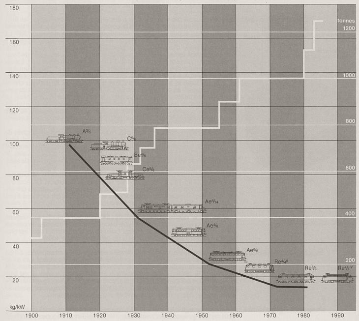
Charge maximale des attelages (t) en rampe de 26‰
