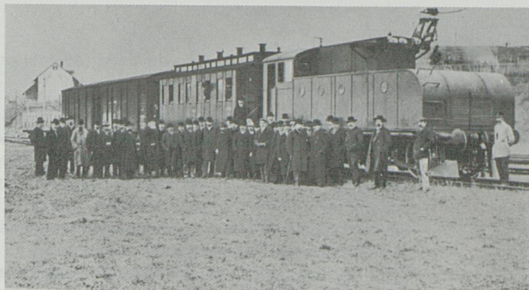
Zug des elektrischen Versuchsbetriebes «Seebach - Wettingen» mit der zunächst als Umformerlokomotive gebauten Lokomotive Nr. 1 anlässlich einer Vorführung am 12. März 1904
