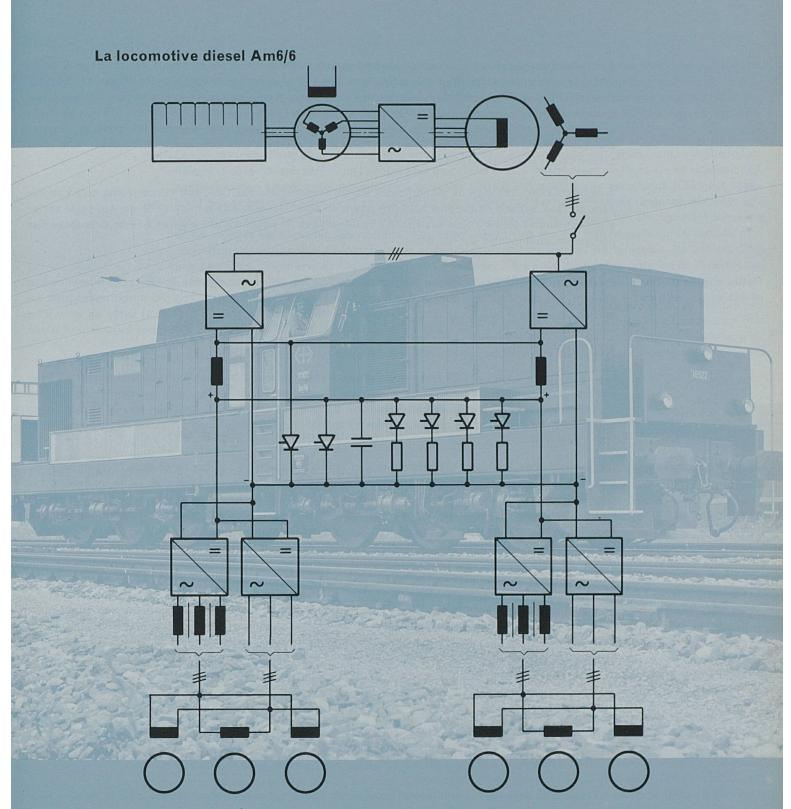
La locomotive diesel Am6/6 assurera des services de manœuvre dans les grandes gares de triage et la traction de trains de secours. L'emploi de la technique des convertisseurs, des semi-conducteurs et de moteurs triphasés asynchrones contribue à abaisser notablement les frais d'entretien. D'autre part, la masse réduite des moteurs de traction asynchrones diminue les efforts rail-roue dans les courbes.
