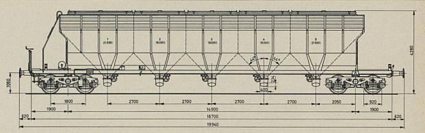
Wagon-trémie du type Uadgs pour le transport de céréales (charge limite 64 t)
