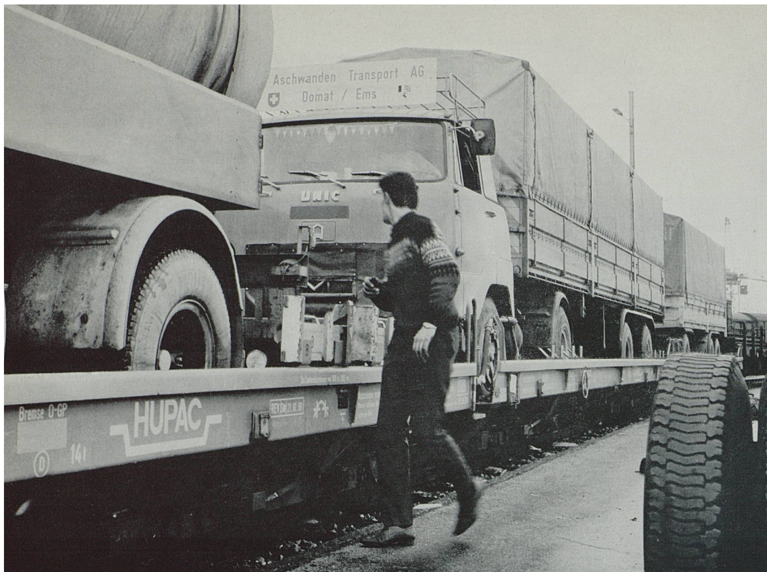
Dans le trafic «kangourou», de gros camions et leurs remorques franchissent rapidement de grandes distances sur des wagons spéciaux.
