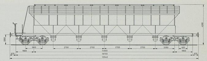
Wagon-silo à bogies pour le transport de céréales et autres marchandises se prêtant au déchargement par gravité.
