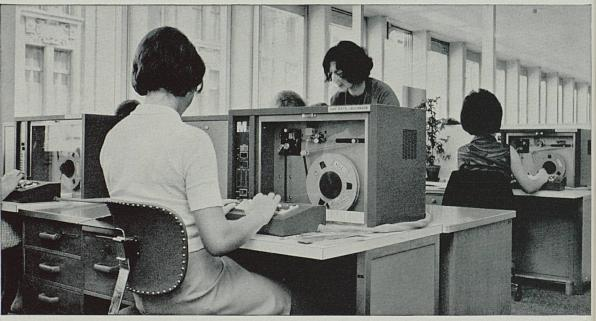
L'enregistrement direct des données sur bandes magnétiques remplace le système des cartes perforées.
