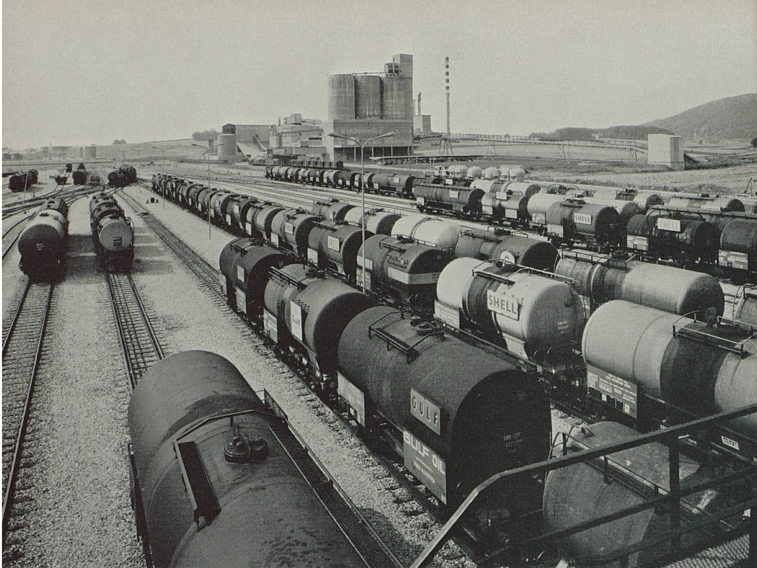
Un raccordement industriel à grand trafic.— Le vaste faisceau de voies de la raffinerie de Cressier, occupé par des wagons-citernes en instance de départ pour Cornaux, où sont formés les trains-blocs et les convois à destination unique, pour des zones ou des centres de consommation déterminés.
