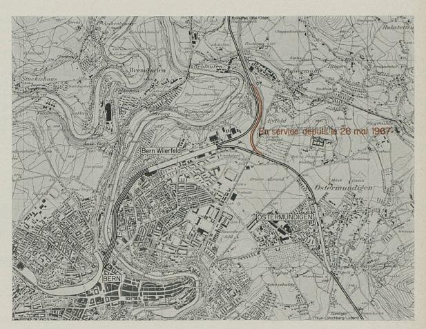
Depuis l'ouverture de la ligne de raccordement à double voie Zollikofen-Ostermundigen, en mai 1967, il est possible d'éviter la gare de Berne sans rebroussement, ce qui facilite beaucoup la circulation des trains en transit passant par Olten et Bienne en direction du Lötschberg et du Simplon.
