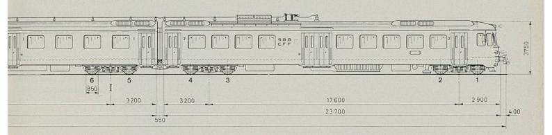
Nouvelle automotrice triple pour le service de banlieue Zurich-Meilen-Rapperswil (entraînement direct de tous les essieux, équipement électronique de commande, attelage automatique permettant de réunir jusqu'à 12 éléments pour la marche en unités multiples).
