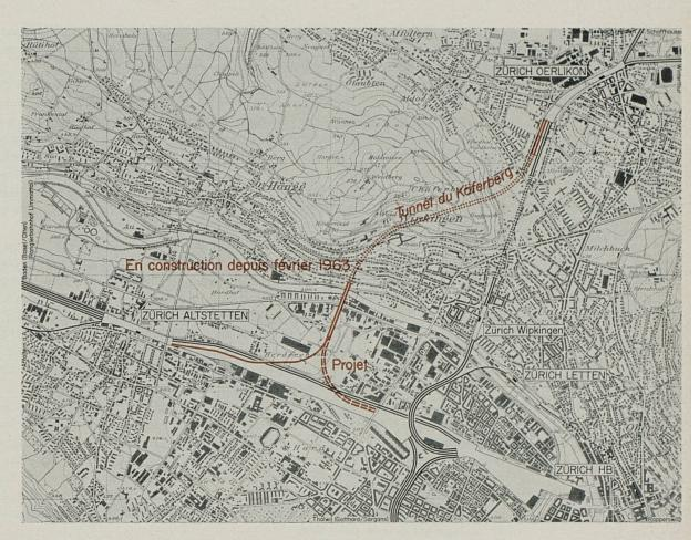
A partir du changement d'horaire de 1969, la ligne de raccordement Zurich Oerlikon-Zurich Altstetten, dont les principaux ouvrages sont le tunnel du Käferberg, long de 2118 m, et, dans son prolongement, le viaduc du Hardturm, long de 1100 m, déchargera la double voie Zurich gare principale-Wipkingen-Zurich Oerlikon d'une partie de son trafic et permettra de contourner la grande gare. Elle prendra toute son importance après le transfert du triage dans la vallée de la Limmat.
