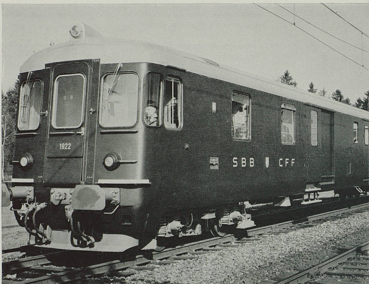
Nouvelle voiture de commande pour trains-navette. Grâce à leur aménagement intérieur, ces véhicules peuvent être utilisés au gré des besoins comme fourgon, ambulant postal ou fourgon à compartiment postal.
