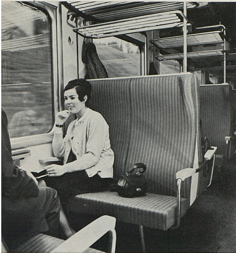
Prototype de la nouvelle voiture unifiée de 2 e classe. Particularités: bourrelets de caoutchouc au lieu de soufflets, fenêtres à double glace, lampes fluorescentes et sièges de conception nouvelle.
