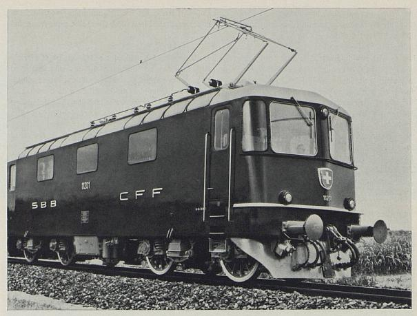
La nouvelle locomotive Re 4/4<sup>11</sup>, dont la puissance unihoraire est d'environ 6500 CV, est destinée au remorquage des trains intervilles lourds et des trains de marchandises sur les lignes de plaine ainsi qu'à la traction multiple sur les parcours de montagne. La comparaison des diagrammes de marche reproduits ci-dessous illustre les gains de temps procurés par cette puissante machine, en regard des performances de sa devancière, la locomotive Re 4/4¹ (environ 2500 CV).
