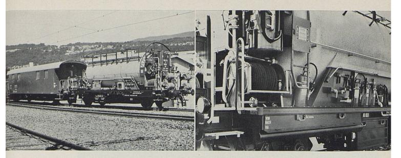
Le nouveau train extincteur des CFF, comprenant un véhicule moteur indépendant des lignes de contact, un wagonréservoir et une voiture-ambulance.
