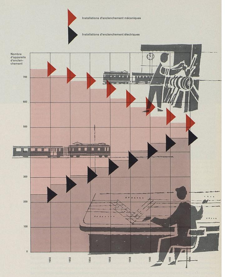
Les Chemins de fer fédéraux appliquent continuellement les dernières conquêtes de la technique à leurs installations de sécurité. Le nombre des installations d'enclenchement mécaniques diminue constamment, alors que celui des appareils d'enclenchement électriques augmente sans cesse.
