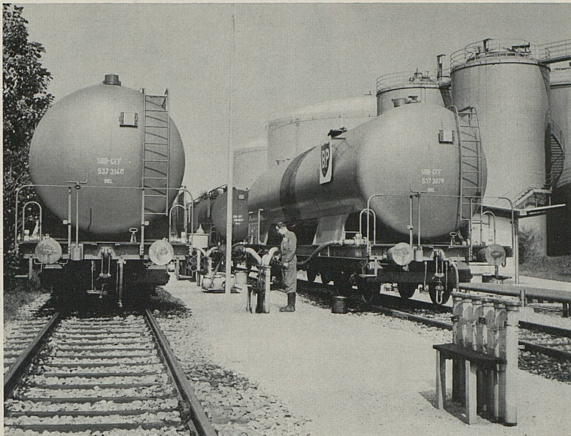
Dépotage de nouveaux wagons-citernes à quatre essieux, d'un poids brut de 80 tonnes.
