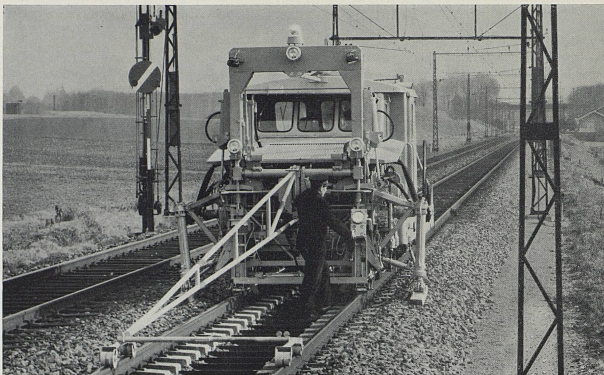
Pour la pose et l'entretien de la voie, nous utilisons de plus en plus des engins modernes de conception suisse. Cette bourreuse-niveleuse automatique soulève la voie à la hauteur désirée et corrige au besoin la différence de niveau entre les deux files de rails; en l'espace d'une heure, elle est capable de bourrer les traverses sur 200 m de voie
