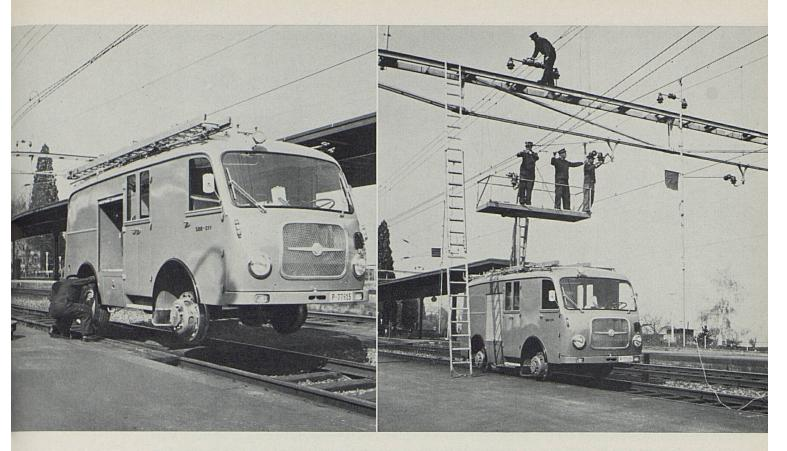
véhicule combiné. Nous nous proposons plutôt de recourir à une construction un peu plus simple, dérivée d'une voiture de série
