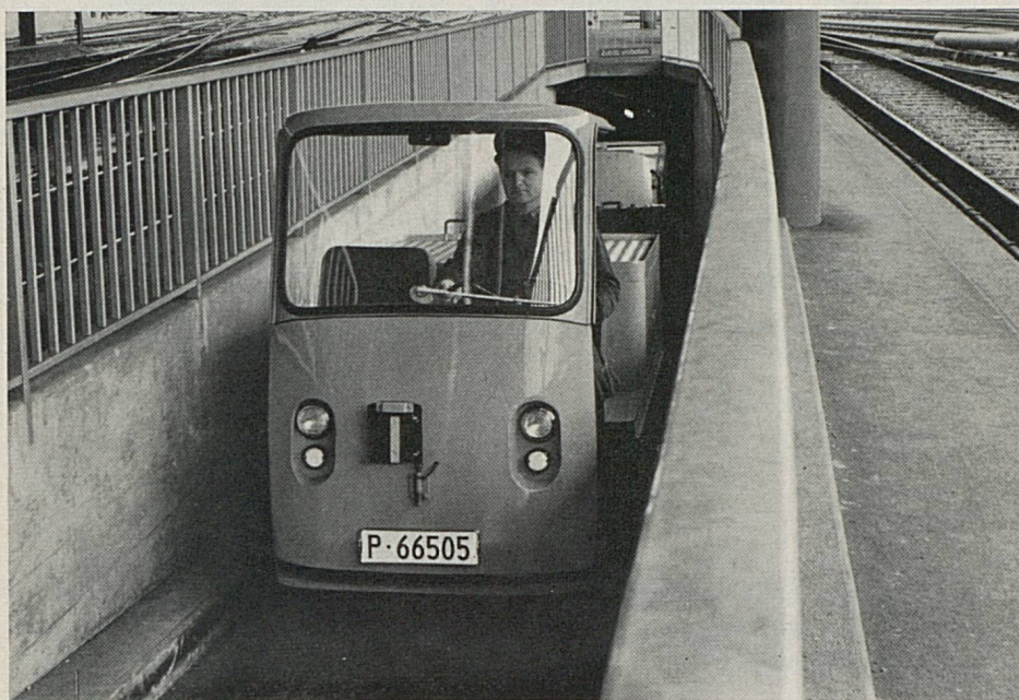
Un des nouveaux tracteurs électriques à quatre roues pour le service des bagages. Sur les rampes des tunnels à bagages, ces véhicules, dont la vitesse maximum est de 18 km/h, peuvent remorquer une charge de quatre tonnes à quatre km/h.
