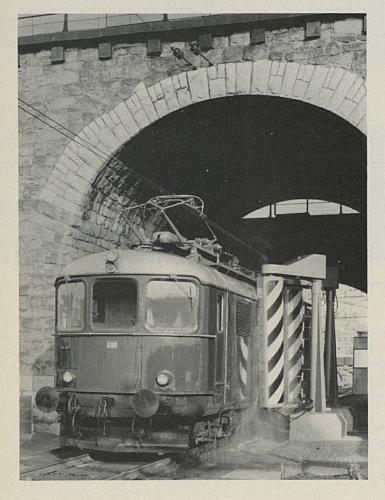
Nettoyage mécanique d'une locomotive Re 4/4
