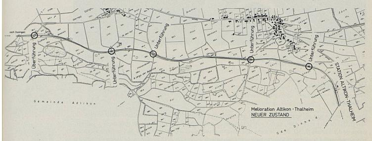
primer des passages à niveau et de les remplacer par des passages inférieurs. A gauche, l'état ancien; à droite, l'état futur.
