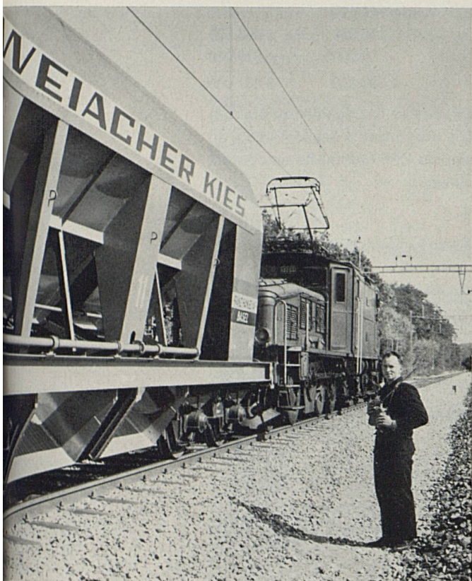
Les wagons spéciaux à déchargement par gravité amènent le gravier et le sable jusqu'aux chantiers des autoroutes.
