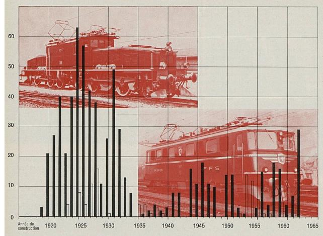
Classement des véhicules moteurs électriques par rang d'âge (Nombre de véhicules moteurs mis en service chaque année)
