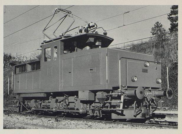
Locomotive de manœuvre de la série Ee <sup>3</sup>/<sub>3</sub> <sup>IV</sup> prévue pour quatre systèmes de courant: 15 kV 16<sup>2</sup>/<sub>3</sub> Hz (CFF), 3 kV courant continu (FS, Chiasso), 1,5 kV courant continu (SNCF, Genève), 25 kV 50 Hz (SNCF, Bâle)
