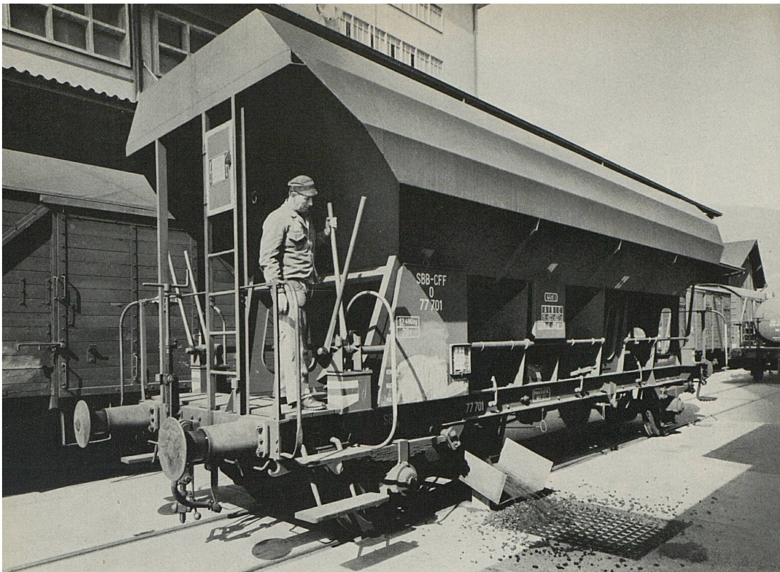
Avec les nouveaux wagons à déchargement automatique pour le transport du charbon et du coke, on peut déverser la marchandise directement dans une fosse
