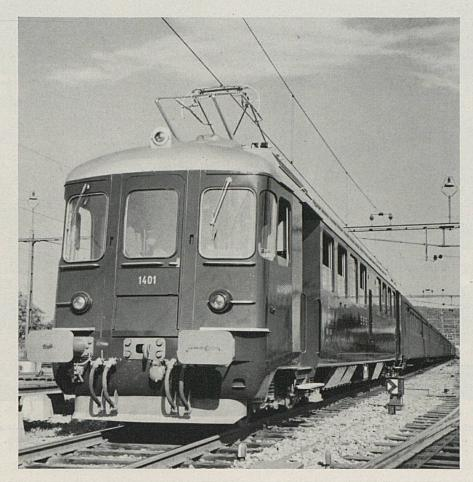
Photo de gauche: nouvelle automotrice RBe 4/4 remorquant un trainnavette entre Genève et Zurich. Puissance unihoraire des moteurs à 80 km/h: 2800 CV. Vitesse maximum: 125 km/h. Nombre de places assises: 68
