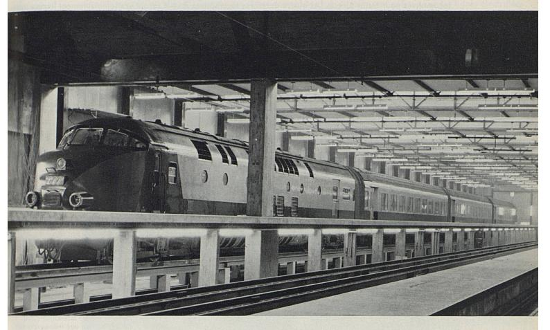
Moderne et confortable, la rame TEE a pénétré dans la nouvelle halle du dépôt de Zurich, où elle sera l'objet de soins attentifs. Grâce à la plateforme surélevée, les ouvriers peuvent travailler rationnellement à deux niveaux différents.
