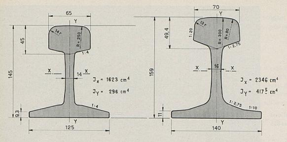
A gauche: Profil de rail CFF I 45,93 kg/m
