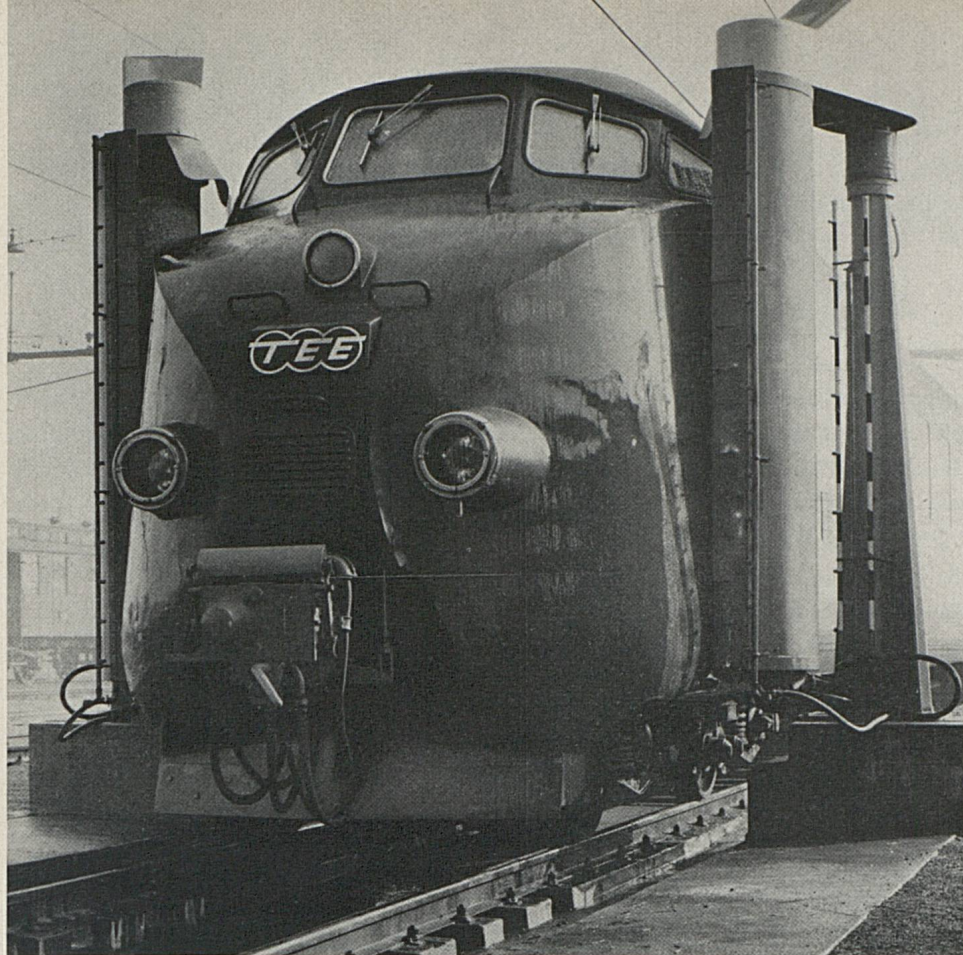
Le Trans-Europ-Express (TEE) fait toilette : la rame doit être impeccable aussi bien à l'extérieur qu'à l'intérieur. La composition est d'abord passée au jet, puis elle est déplacée entre des brosses verticales, qui la nettoient mécaniquement
