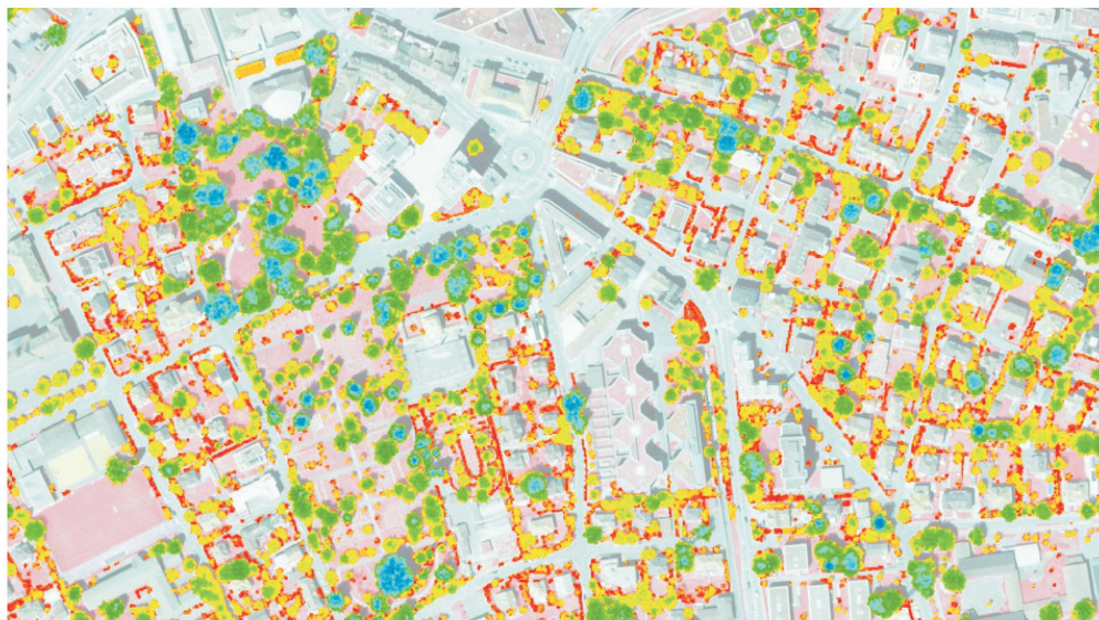
Abb. 4 Aus den LiDAR-Daten abgeleitete Kronenvolumen für Bäume ab 3 Meter bis über 20 Meter Wuchshöhe in der Stadt Aarau (gleicher Ausschnitt wie Abb. 2).
