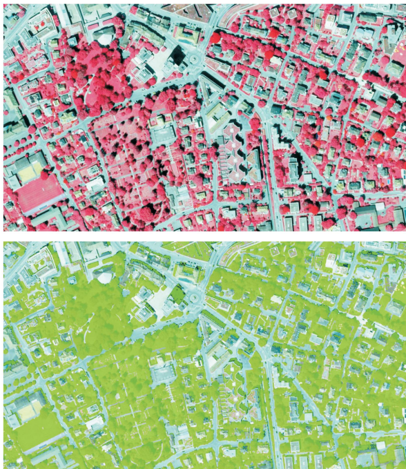
Abb. 2 a, oben Orthophoto der Stadt Aarau aus dem Jahr 2022 im nahen Infrarotbereich, das als Grundlage für die Ausscheidung des NDVI dient.
