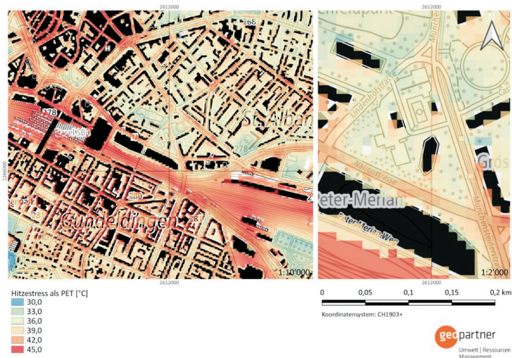
Abb. 6 Der Hitze- stress in der heutigen Bebauungssituation auf dem Lindenhofareal und Umgebung. Blaue Einfärbungen bedeuten einen geringeren Hitze- stress als rötliche Einfä- rbung.
