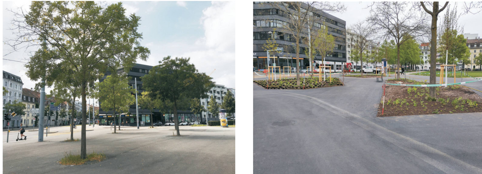
Abb. 1 Kleinräumige Entsiegelung zur Verbesserung der Regenwasser-Versickerung am Beispiel Voltaplatz. Vorher (links): einzelne Bäume mit kleinen Pflanzgruben. Nachher (rechts): entsiegelte Flächen rund um die Bäume, zusätzliche Bäume in zusammenhängenden bepflanzten Rabatten.
