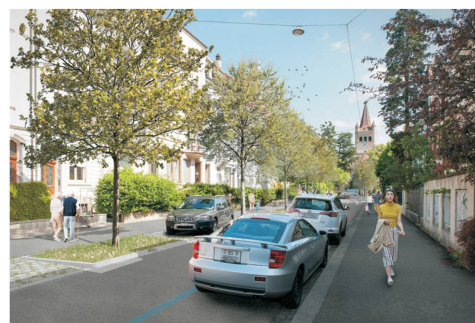
Abb. 4 Bild Therwilerstrasse vor (links) und Visualisierung nach (rechts) der Umgestaltung. Neu entsteht eine schattenspendende Baumreihe, wobei die Grünflächen als Mulden ausgeführt werden, um das zufließende Regenwasser von den umliegenden Flächen aufzunehmen. Zwischen den Grünflächen werden Parkplätze mit durchlässigen Rasenfugensteinen entstehen.
