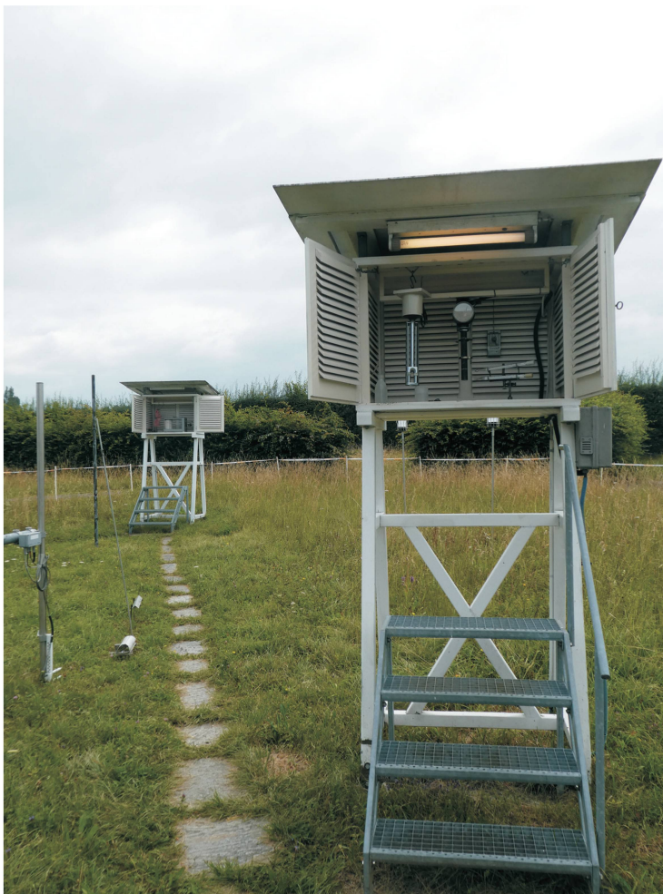
Abb. 1 Die beiden Wetterhütten der Station Basel-Binningen. In der hinteren Wetterhütte erfolgt die Registrierung der Temperatur mit einem Thermographen im Tagesumlauf. In der vorderen Wetterhütte sind die Messgeräte für Temperatur, Luftfeuchtigkeit und Extremtemperaturen erkennbar.
