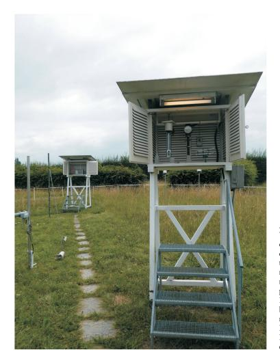
Abb. 1 Die beiden Wetterhütten der Station Basel-Binningen. In der hinteren Wetterhütte erfolgt die Registrierung der Temperatur mit einem Thermographen im Tagesumlauf. In der vorderen Wetterhütte sind die Messgeräte für Temperatur, Luftfeuchtigkeit und Extremtemperaturen erkennbar.
