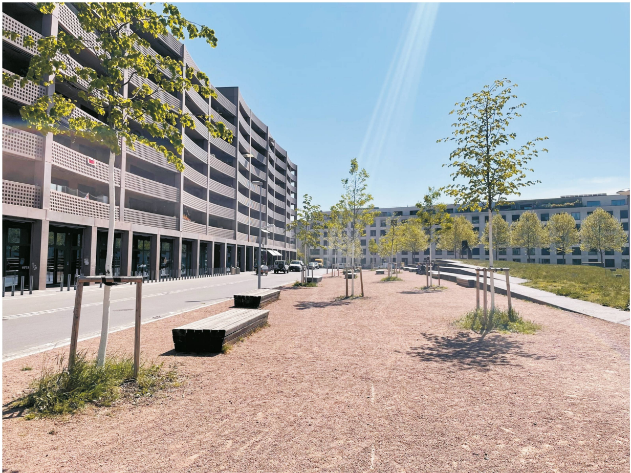
Abb. 2 Erste Schwammstadt-Massnahme auf der Erlenmatt im Triangel am VoltaNord. Anstelle eines Hartbelags wurde ein wasserdurchlässiger Kiesplatz mit 18 Bäumen umgesetzt.
