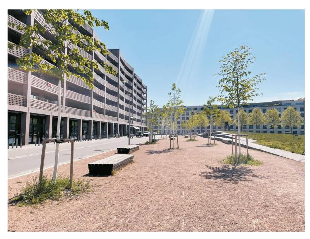
Abb. 2 Erste Schwammstadt-Massnahme auf der Erlenmatt im Triangel am VoltaNord. Anstelle eines Hartbelags wurde ein wasserdurchlässiger Kiesplatz mit 18 Bäumen umgesetzt.
