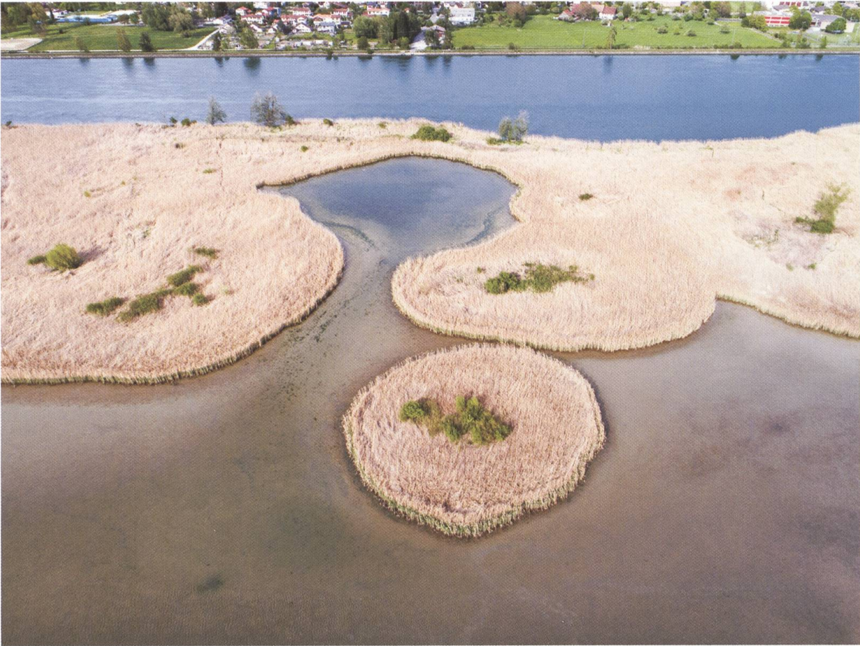
Abb. 2 Renaturierung statt Siedlungswachstum: Ausbaggerung Altarm Gippinger Grien westlich des Kraftwehrs bietet mit Röhricht, Ried und Weidengehölzen, Altwasser, Giessen und periodisch wasserführenden Gräben eine Vielzahl von typischen Auelementen. Blick von der Aussichtsplattform des Auenparks Aargau auf den Klingnauer Stausee. Durch das Schaffen eines durchströmten Bereichs (Hintergrund) und einem verlandenden Flachwasserbereich (vorne) wurden unterschiedliche Lebensräume zur Erhöhung der Biodiversität geschaffen. Quelle: Auenschutzpark Aargau
