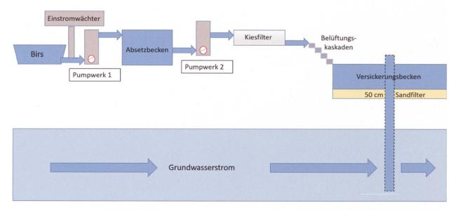
Abb. 5 Schema der Versickerungsanlage Chueweid in Aesch. Eine Tafel mit einer schematischen Darstellung ist vom Uferweg aus gut sichtbar.
