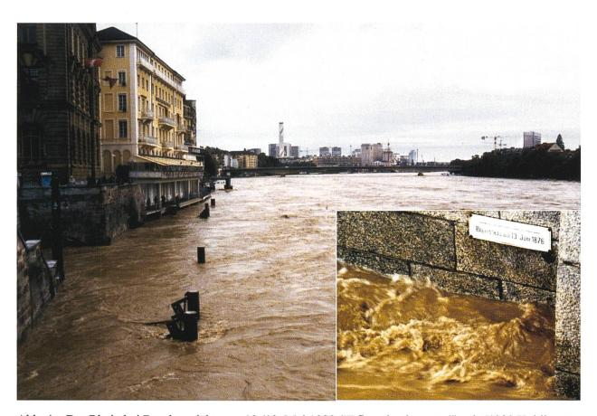
Abb. 4 Der Rhein bei Basel erreichte am 12./13. Mai 1999 ("Pfingsthochwasser") mit 5'090 Kubikmeter pro Sekunde den grössten Abfluss seit 1876 (Hochwassermarke am Kleinbasler Brückenkopf). Anhaltende Niederschläge auf der Alpennordseite führten zusammen mit der Schneeschmelze zu nie gekannten Hochständen der Alpenrandseen und zu Höchstabflüssen.
