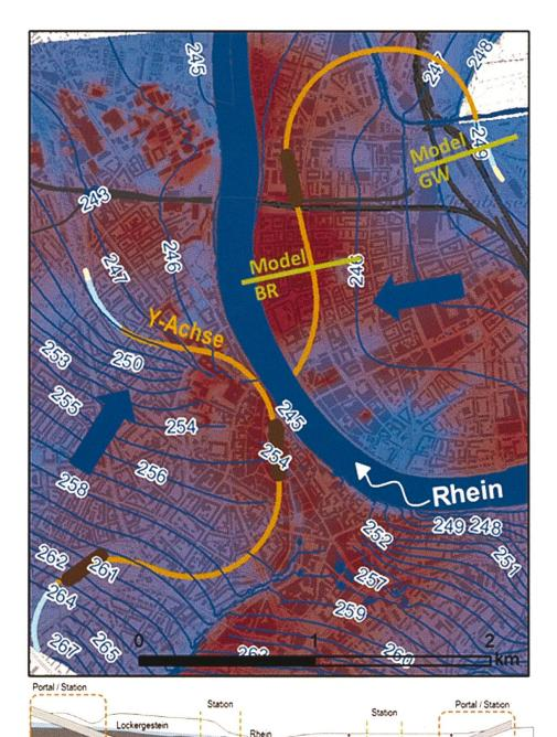
Abb. 3 Oben: S-Bahn "Herzstück" (grün: Standorte lokale 3D-Wärmetransportmodelle zur Evaluation der geothermischen Nutzung von TAS). Mittleres simuliertes Temperatur-und Grundwasserregime für die Jahre 2010 bis 2015 (Mueller et al. 2018).
