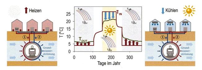
Abb. 4 Saisonale thermische Nutzung des TAS in der äusseren Tunnelwand im Kontakt mit dem Untergrund (Grundwasser-gesättigte Lockergesteine) als Wärmeerzeuger zur Gebäudeheizung im Winter (links) und zur Gebäudekühlung im Sommer (rechts). Mitte: Standard-Funktionsweise des TAS auf Grundlage einer vorgegebenen Eintritts- (Tin, rot) und der resultierenden Austrittstemperatur (Tout, grün) im Winter und Sommer.
