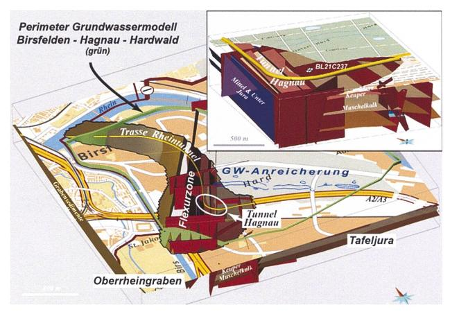
Abb. 2 Ansicht des geologischen 3D-Modells von SW und vergrösserte Ansicht im Bereich Tunnel Hagnau; rote Flächen stellen Verwerfungen dar; Topographie ist partiell ausgeschnitten; Felsoberfläche ist nicht dargestellt.
