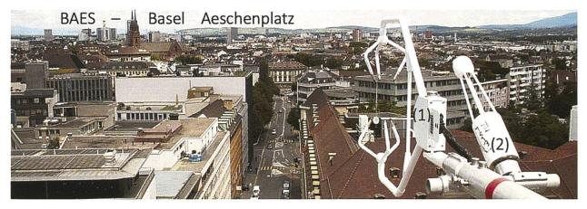
Abb. 1 Eddykovarianz-Perspektive der beiden Messtürme Klingelbergstrasse (Messreihe seit 2004) und Aeschenplatz (Messreihe seit 2009). Die Instrumentierung besteht jeweils aus einem Ultraschallanemometer für die Messung der Windfluktuaktionen (1) und einem Gasanalysator für die Messung der Konzentrationsfluktuationen von Wasserdampf und Kohlendioxid (2).
