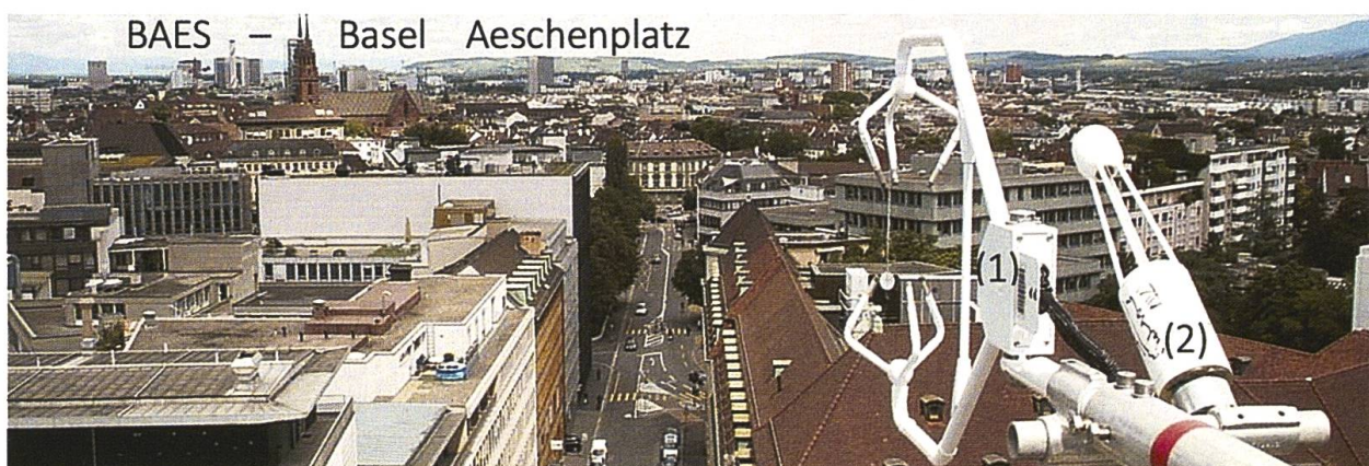
Abb. 1 Eddykovarianz-Perspektive der beiden Messtürme Klingelbergstrasse (Messreihe seit 2004) und Aeschenplatz (Messreihe seit 2009). Die Instrumentierung besteht jeweils aus einem Ultraschallanemometer für die Messung der Windfluktuationen (1) und einem Gasanalysator für die Messung der Konzentrationsfluktuationen von Wasserdampf und Kohlendioxid (2).
