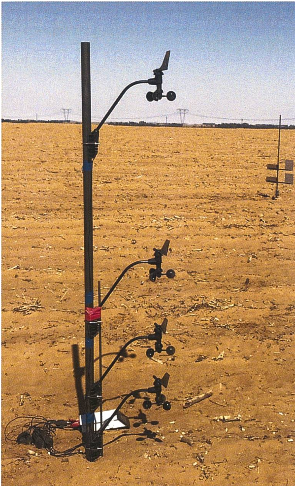
Abb. 4 Anemometermast auf einem abgeernteten Erdnussfeld (links) und BSNE Sedimentfallen auf einem abgeernteten Maisfeld (rechts) in der Nähe von Bultfontein, Free State, Südafrika.
