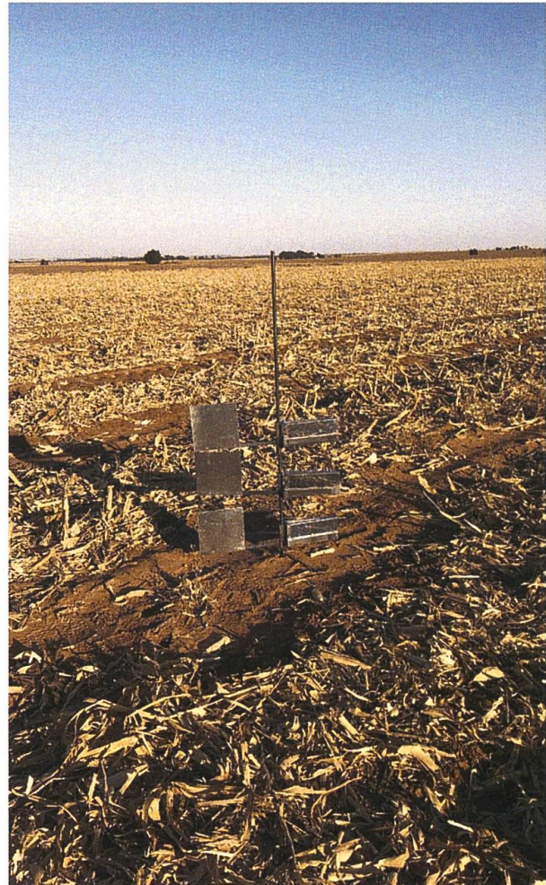
Abb. 4 Anemometermast auf einem abgeernteten Erdnussfeld (links) und BSNE Sedimentfallen auf einem abgeernteten Maisfeld (rechts) in der Nähe von Bultfontein, Free State, Südafrika.
