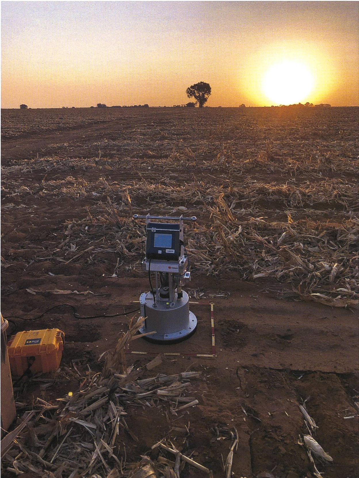
Abb. 3 Portable In-Situ Wind Erosion Laboratory (PI-SWERL) bei der Messung des Schwellenwertes der Windgeschwindigkeit zur Mobilisierung von Staub und dessen Emissionsrate auf einem abgeernteten Maisfeld in der Nähe von Bultfontein, Free State, Südafrika.
