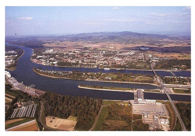
Abb. 6 Der strassenparallele Wiederaufbau der Brücke über den 1960 gebauten Rheinseitenkanal (vorne) und den Rhein sowie die Anbindung an den Breisacher Bahnhof (in der Verlängerung der Strassenbrücke rechterhand der Siedlung erkennbar) stellen die grössten baulichen Herausforderungen einer Reaktivierung der Strecke von Breisach nach Colmar dar.
