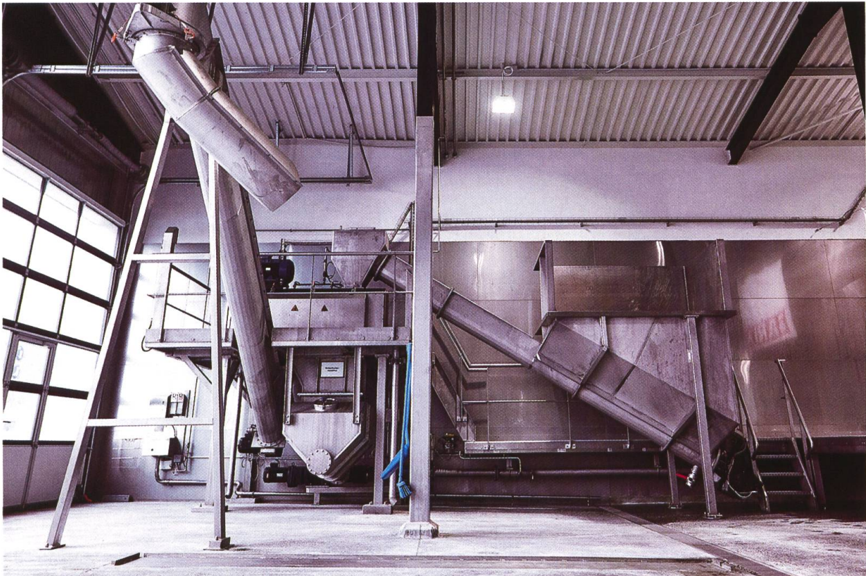
Abb. 5 Separate Entpackungslinie für verpackte Lebensmittelabfälle der Refood-Anlage in Trossingen in Baden-Württemberg. Foto: Refood GmbH & Co. KG
