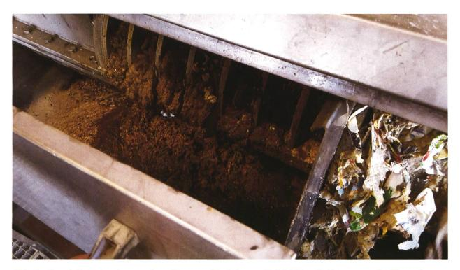
Abb. 3 Spezielle Entpackungsanlage für verpackte Lebensmittelabfälle mit Abtrennung der Verpackungsbestandteile. Foto: M. Zürn
