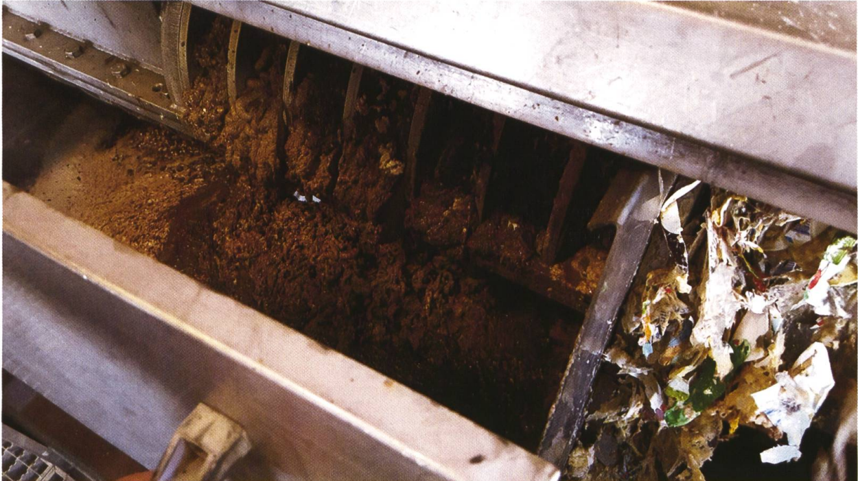
Abb. 3 Spezielle Entpackungsanlage für verpackte Lebensmittelabfälle mit Abtrennung der Verpackungsbestandteile. Foto: M. Zürn
