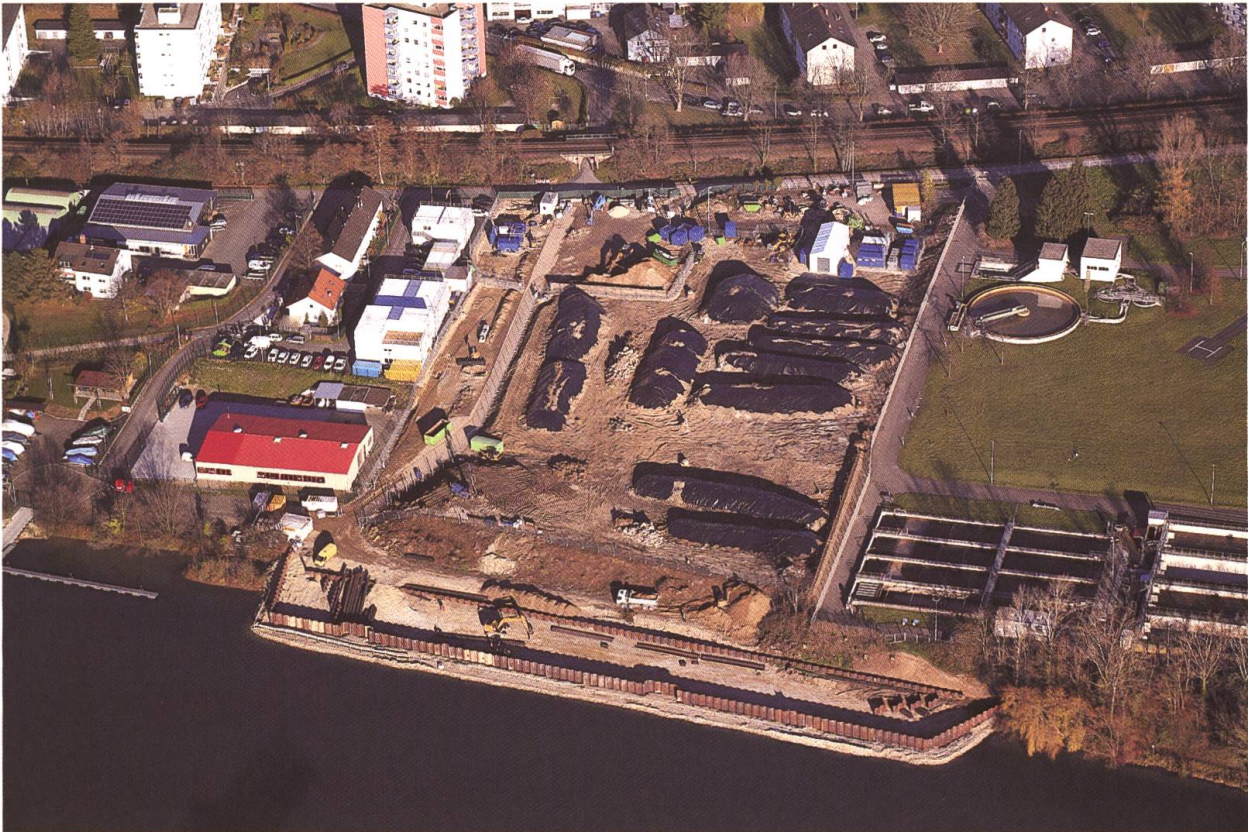
Abb. 6 Luftaufnahme des Sanierungsareals: Zu sehen sind die Haufwerke mit unbelastetem Oberflächen-erdreich nach Nivellierung des Sanierungsareals sowie der im Bau befindliche Schiffsanleger.
