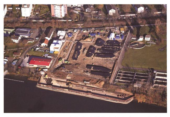
Abb. 6 Luftaufnahme des Sanierungsareals: Zu sehen sind die Haufwerke mit unbelastetem Oberflächenerdreich nach Nivellierung des Sanierungsareals sowie der im Bau befindliche Schiffsanleger.
