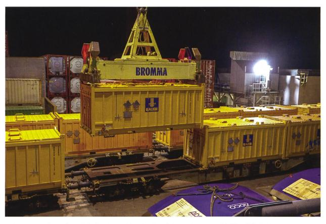
Abb. 17 Im Schweizer Auhafen: Umschlag der Spezialcontainer vom Schiff auf die Bahn.
