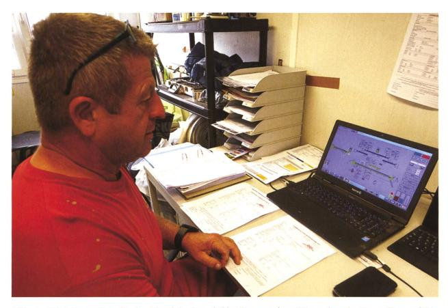
Abb. 6 Die Mischanlage für den Flüssigboden wird im Baucontainer-Büro neben der Baustelle sorgfältig überwacht, denn nur das exakte Mischverhältnis garantiert den Erfolg. Foto: C. Bertoldi
