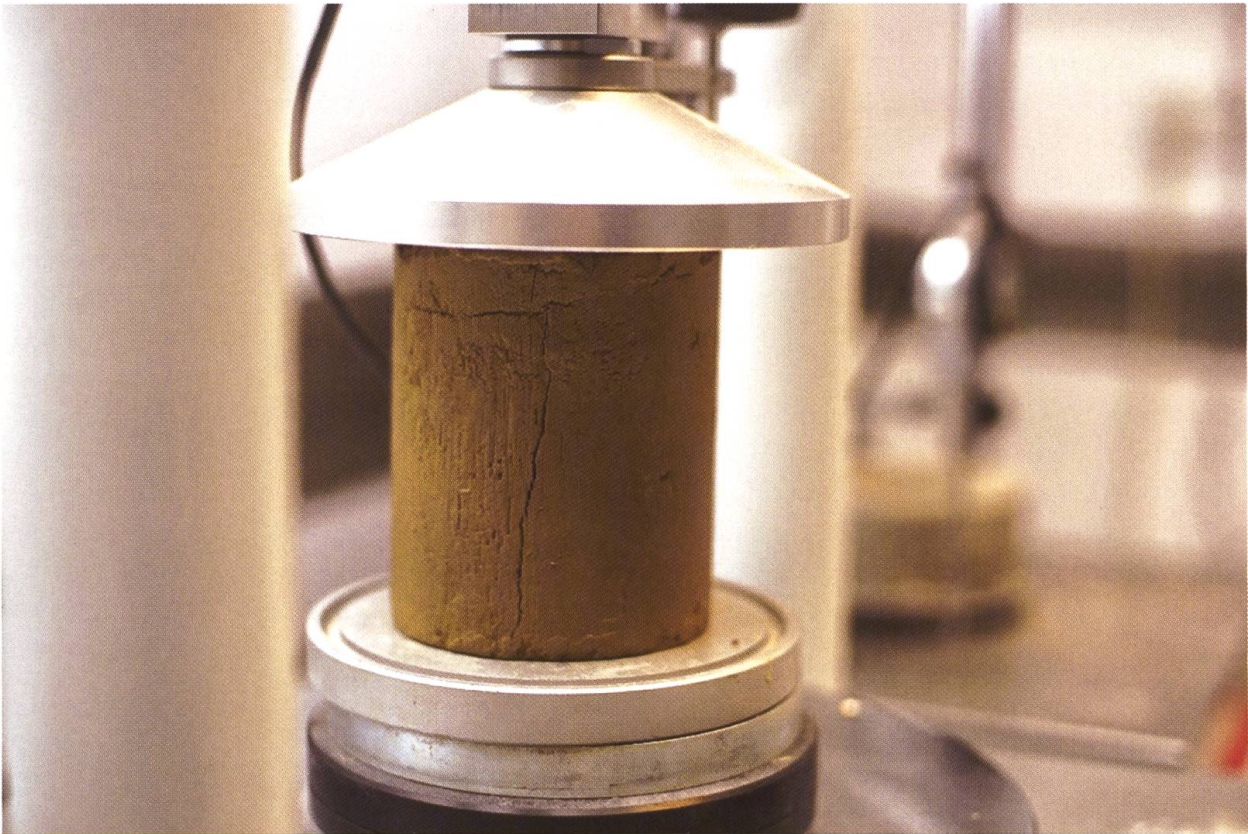
Abb. 7 Eine Flüssigbodenprobe im Labor – der Belastungstest.
