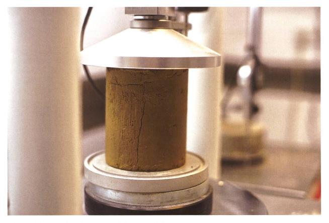
Abb. 7 Eine Flüssigbodenprobe im Labor – der Belastungstest.
