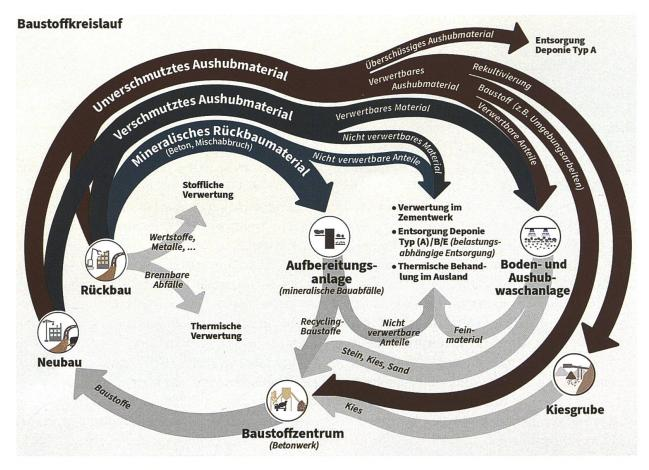
Abb. 3 Schematische Darstellung des Baustoffkreislaufs (🚱<sub>3</sub>).
