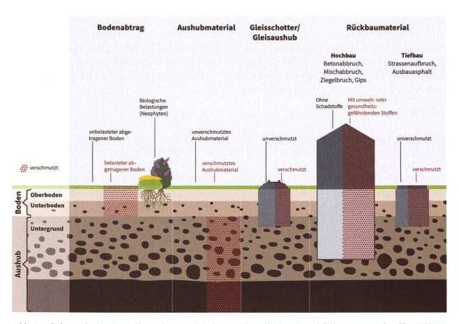
Abb. 1 Schematische Darstellung der verschiedenen mineralischen Bauabfälle.
