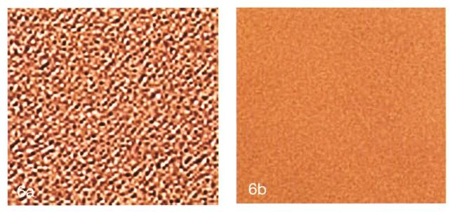
Abb.6a/b Zwei Sandsteine, Abb. 6a mit Körnern von ca. einem Millimeter Durchmesser, Abb. 6b mit Körnern von 75 Mikrometer, aufgenommen im Marslabor aus 10 Metern Entfernung mit der CLUPI-Simulator Kamera. Einzelne Körner können nicht erkannt werden, Unterschiede werden jedoch in Farben der Nachbarpixel deutlich. Diese Information kann zur Gesteinsbestimmung verwendet werden. (Quelle: Marslabor Universität Basel)
