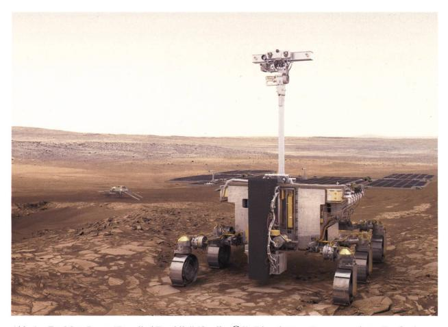
Abb. 1 ExoMars Rover "Rosalind Franklin" (Quelle: ②2). Die schwarze Box am vorderen Kopfende von "Rosalind Franklin" ist ein Probennehmer. Der Close-Up Imager CLUPI ist links am Probennehmer zu sehen. Die Box mit dem Probennehmer kann geschwenkt werden, was CLUPI Aufnahmen zur Seite und über einen Spiegel nach vorne ermöglicht.
