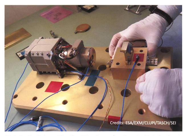
Abb. 3 Der Close-Up Imager während Tests 2019 am European Space Research and Technology Center in Nordwijk, Niederlande. (Quelle: ESA/ EXM/ CLUPI/ TASCH/ SEI)
