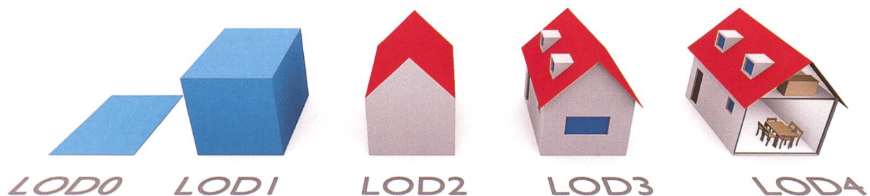
Abb. 4 Die fünf LODs von CityGML 2.0. Geometrische Details und semantische Komplexität steigen mit zunehmender Stufe. (Quelle: Biljecki et al. 2016)
