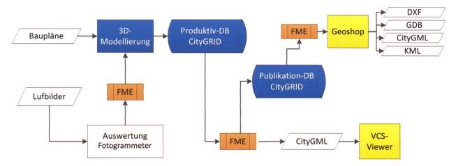
Abb. 3 Vereinfachter Nachführungs- und Ausgabeprozess. Zur Bewirtschaftung des Stadtmodells werden verschiedene Softwarekomponenten eingesetzt (GityGRID in Blau, FME in Orange). Über den Geoshop bzw. den VCS-Viewer (Gelb) wird es den Nutzenden zur Verfügung gestellt.
