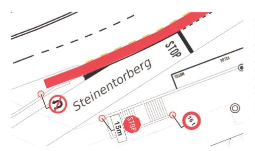
Abb. 4 Situation heute: Stop-Signalisation und verlängerter rot eingefärbter Radstreifen. Nicht sichtbar ist der eingekürzte Radstreifen (Quelle: Verwaltungsinternes Web-GIS, GeoViewer TBA, Tiefbauamt Basel-Stadt 2019, Eingesehen am 23.09.2019).
